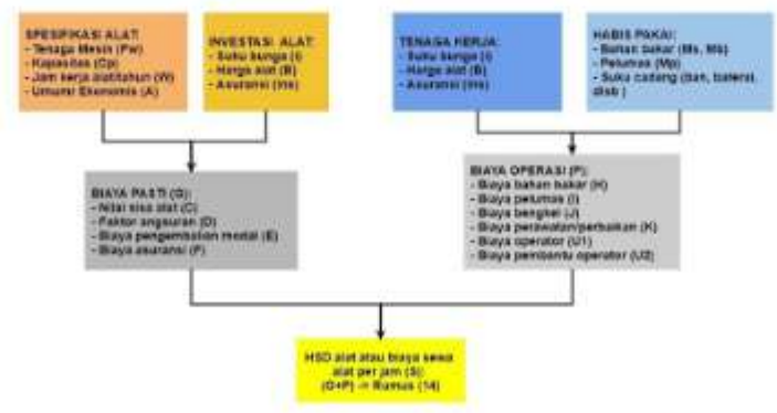
Gambar 2 – Struktur analisis Harga Satuan Dasar (HSD) Peralatan (Mekanis)
